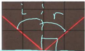
Fig. 2a. Foto av en laserljusstrimma som stryker längs en skärm. Ljusstrimman reflekteras mot en spegel i skärmens nedre kant.
