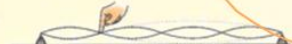
b. Man trycker lätt på samma ställe, varvid grundtonen undertrycks och en övertone framhävs. Dras fiolens stråke på rätt sätt, spelas en flageolet. Den är i sin tur en enda sinusformad svängning, nästan utan övertoner.
