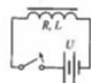
Fig. 12. När strömmen bryts, tvingas strömmen att minska mycket snabbt, och en stor inducerad spänning uppträder över spolen.
