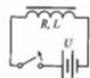
Fig. 12. När strömmen bryts, tvingas strömmen att minska mycket snabbt, och en stor inducerad spänning uppträder över spolen.
