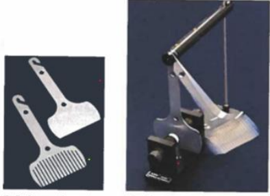
Fig. 7a. Omagnetiska pendlar. b. Pendeln utan spår har tvärtstannat. Den andra fortsätter att svänga, eftersom spåren minskar framkomligheten för virvelströmmar och därmed bromseffekten.
