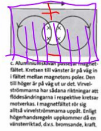
c. Aluminiumskivan passerar magnetfältet. Kretsen till vänster är på väg in i fältet mellan magnetens poler. Den till höger är på väg ut ur det. Virvelströmmarna har sådana riktningar att flödesändringarna i respektive kretsar motverkas. I magnetfältet rör sig alltså virvelströmmarna uppåt. Enligt högerhandsregeln uppkommer då en vänsterriktad, d.v.s. bromsande, kraft.
