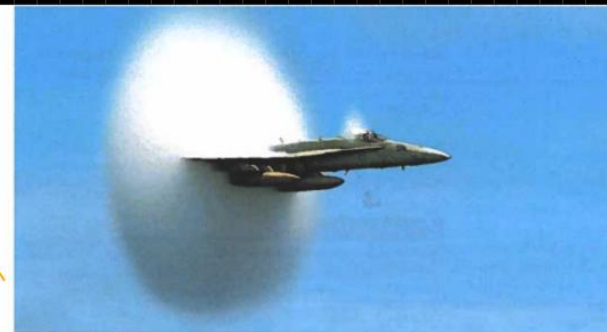
Fig. 2. Ett militärflygplan som just överskridit ljudhastigheten. Tryckökningen vid den resulterande "ljudbängen" har fått luftfuktighet att kondenseras till ett moln av små vattendroppar.
